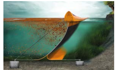
Öljyä eristävä rakenne vedessä
