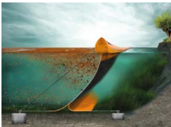
Öljyä eristävä rakenne vedessä
